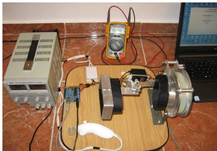
Fig. 1. Sistem electromecanic de reabilitare a mobilității membrului superior
